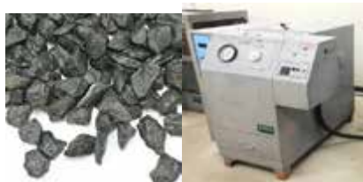
7号碎石（玄武岩） 飛石試験機 （3.2～4.8mm） （スガ試験機 JA400） （JIS A5001 準拠）
