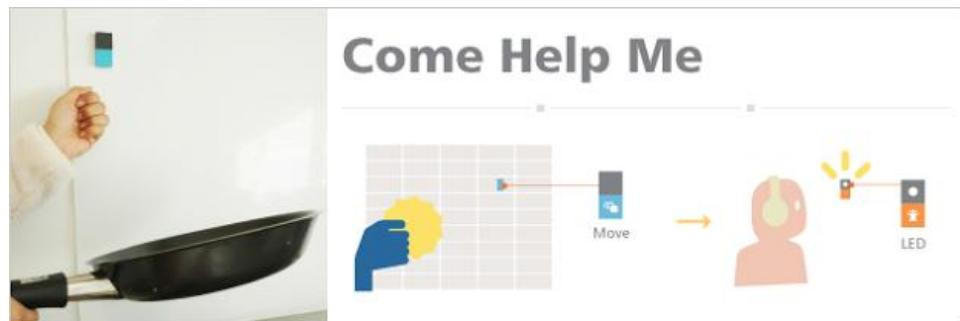
異なる機能の MESH タグを組み合わせて便利な仕組みを発明することもできます。例えば、料理中で手がふさがっている時、手伝いに来てほしいのに、子どもは違う部屋でヘッドフォンから流れる音楽に夢中。そんな時は、水色の MESH タグ（動きセンサー）を付けたキッチンの壁をノックすれば、子どもの手元にあるオレンジ色の MESH タグ（LED ライト）が点灯し、呼ばれたことが一目でわかります。
