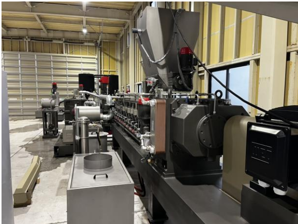
押出プラント(設置中の様子)
