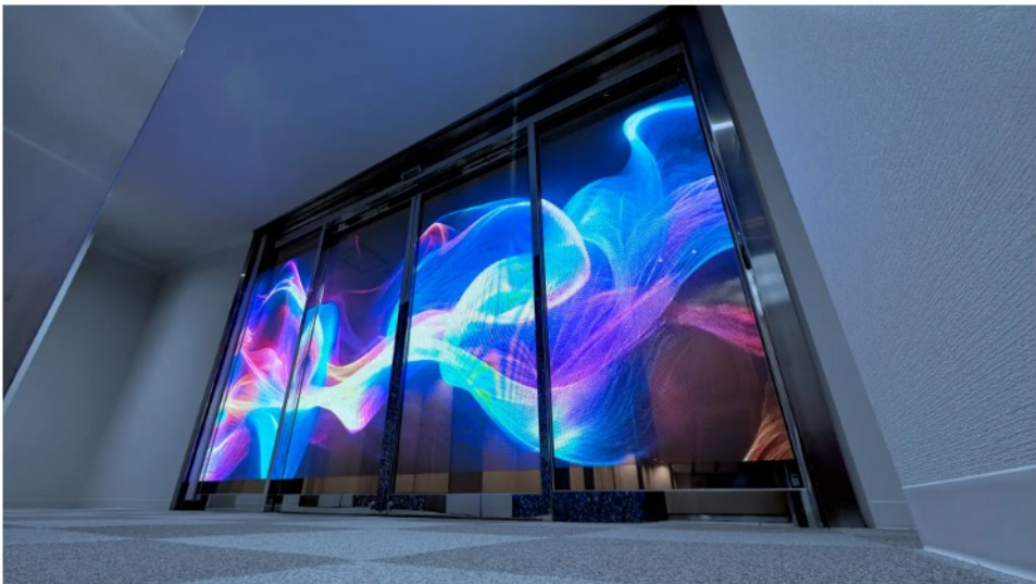
透過型LEDサイネージ「自動ドアサイネージ」
