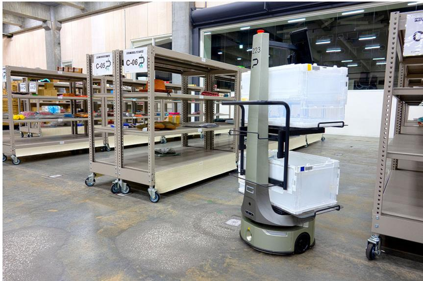
オカムラとの共同開発によるフレームを搭載し、ピッキングや品出し両業務への対応を実現した自律型協働ロボット『PEER ST』
