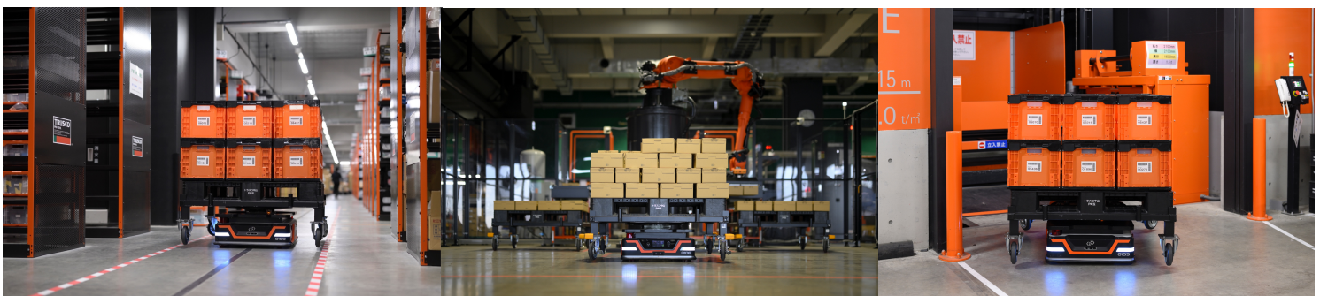
「プラネット埼玉」で稼働する自律型協働ロボット『Oasis 600C』 (左より)作業工程間搬送、パレタイズロボット連携、垂直搬送機連携
