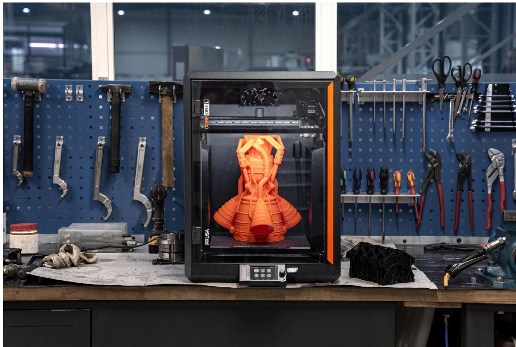
作業場に置いた Prusa CORE One L。試作や治具を、外注に出さずその日のうちに形にできる（写真提供：Prusa Research）
