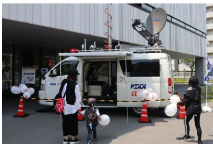
<衛星回線システム搭載の車載型基地局 / 災害時空撮ドローン“持ち上げてみようチャレンジ”>
