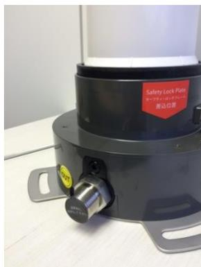
浄水器側面に設置されたダイヤルを調整することで塩素濃度の調整が簡単にできます。
