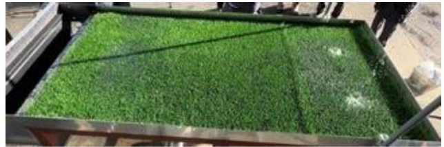
従来工法 (降雨量 150mm/h、散水開始から 20 分後)
