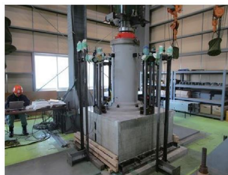
実物大の載荷試験状況(新型支承板の例)
