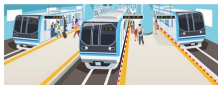
線路及びホームの増設(2面3線化)
