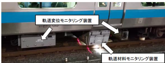
線路設備モニタリング装置（JR 東日本提供）
