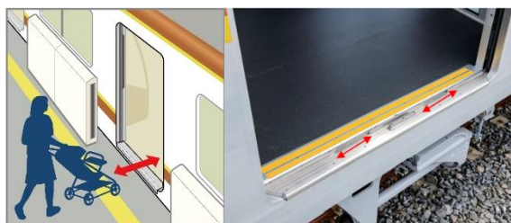
ドアレールの切り欠き（フリースペース付近）
