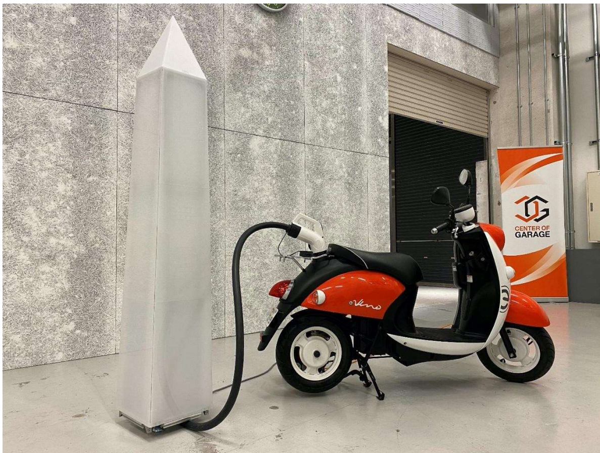
急速充電用バッテリーモジュールを搭載した電動バイクとBCP機能を有する急速充電ステーション
