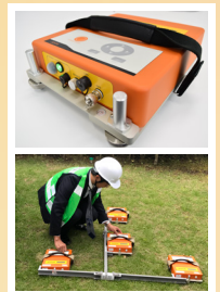
▲微動探査装置「地震eye」 (地盤ネット総合研究所株式会社)
