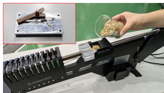
<写真3：金型と成形加工機>
