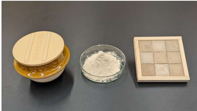
<写真：左）「峠の釜めし」の釜、 中）処理をした材料、 右）作成した内装用タイル>
