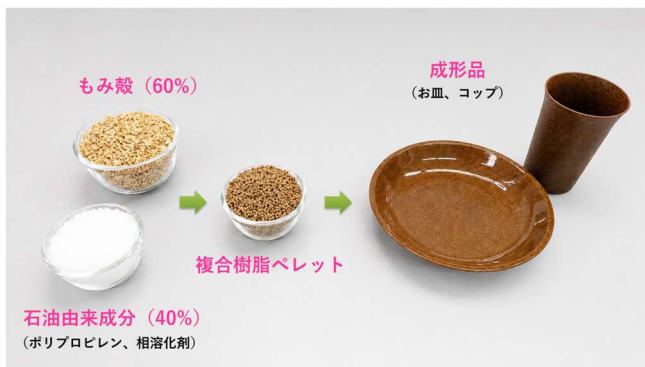
<写真 1：もみ殻 60%含有プラスチック製食器の製作プロセス> <写真 2：実際のカフェで使用中的のもみ殻プラ食器>
