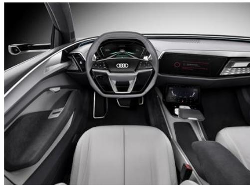
ドライバーを含めて 4 人の乗員には、それぞれ独立したシートが用意されています。リヤシートにもたっぷりとしたレッグルームとショルダールームが確保されています。ステアリングホイール背後とセンターコンソールの大型ディスプレイは、稼働していないときは黒いパネルに見えるだけですが、クルマのスイッチを入れると、たちまちディスプレイが浮き上がりきます。こうしたデザインは、ミニマルなデザイン美を追求した現代の民間用航空機のコックピットを彷彿とさせます。助手席の前の垂直の面にも、ナビゲーションデータや天候情報、外気温などを提示する横長のディスプレイが収められています。ラゲージコンパートメントは、通常の状態では 550ℓ の容量を備え、リヤシートを完全に折り畳むと、最大 1,450ℓ まで拡大することができます。
