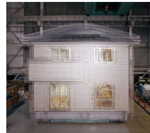
国内最大級の実験施設の 油圧能力の限界に挑戦した 耐震実験
