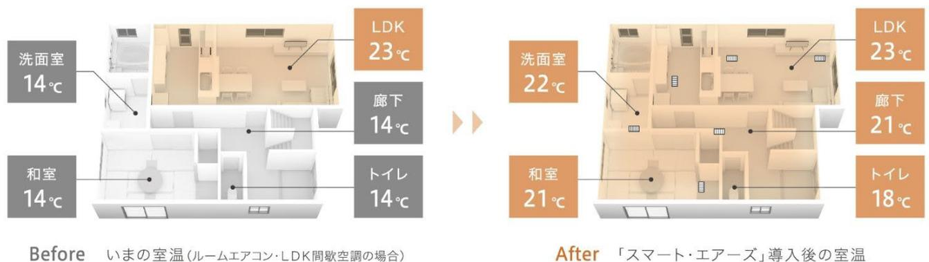
滋賀県モニター邸での実測値【モニター邸 延床面積：136.12㎡、UA値：0.92W/㎡K、ηAC値：2.9】【いまの室温】設定温度22℃でLDKエアコン暖房運転(運転スケジュール 6～10時、12～14時、16～24時)。各室温は20時(16時運転開始の4時間後)の値。日平均外気温度：7℃(20時の外気温度：8℃)【スマート・エアーズを1階+2階に導入後の室温】設定温度22℃で連続暖房運転。空調吹出口はLDK、和室、洗面室、廊下に設置。各室温は20時の値。日平均外気温度：7℃(20時の外気温度：7℃)
