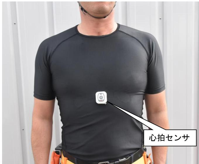
左：現場管理者が作業員の状況をタブレット端末で確認、右：ウェアラブルセンサを装着する作業員
