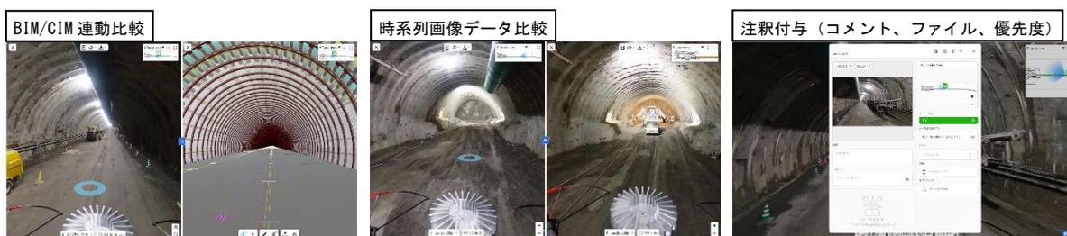
図 2 現場モニタリングシステム (OpenSpace) による巡視点検
