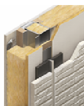
外張断熱通気外壁
