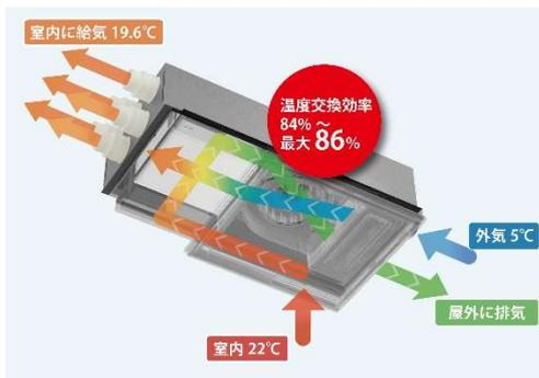
【第1種熱交換型換気システム「風なびRXIII」】
