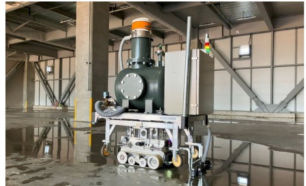
水替えアタッチメントを搭載した自動搬送ロボット（東急建設〈左〉、フジタ〈右〉）
