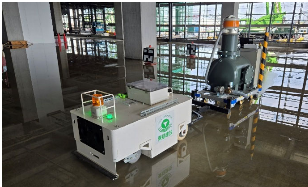
水替えアタッチメントを搭載した自動搬送ロボット（東急建設〈左〉、フジタ〈右〉）
