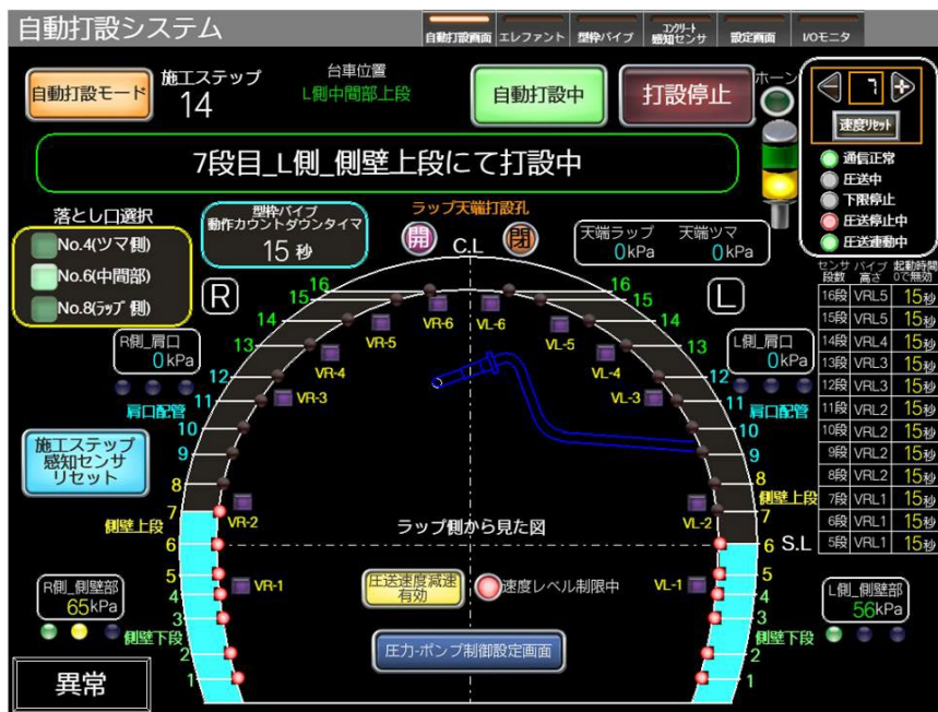
ポンプ圧送速度制御システム
