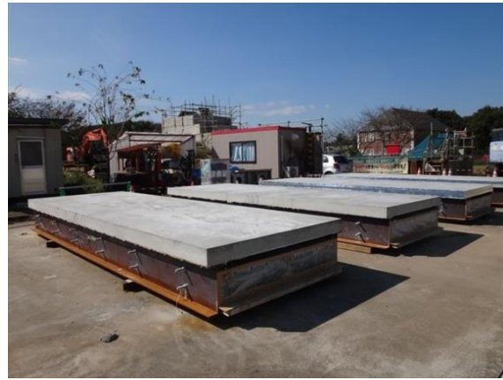
実大デッキスラブ試験体
