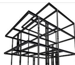
【重量鉄骨ラーメン構造】
