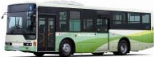
**MFTBC 新型大型路線バス「エアロスター」は、アリソン A/T 「T310」を搭載。ポスト新長期排出ガス規制および平成 27 年度重量車燃費基準を達成。**
