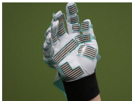
手に圧力センサーを貼り付けた状態
