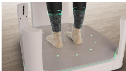
▲非接触での高精度 3D スキャン
