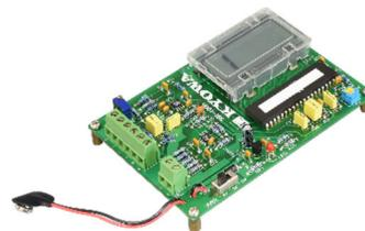
教材用ひずみゲージアンプ
