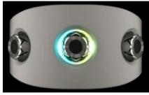
実験機の重要なポイントである「動くことで発生する風切り音を」、3つのマイクによって取得。さらに6軸センサーを組み合わせることで、微細な動きやメリハリのある動きなどを、様々な音色で魅せるシームレスな表現が可能に。スペシャルサイトでは製作段階デザインスケッチも公開中です。
