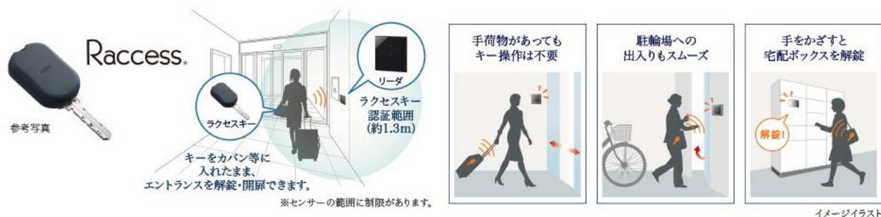
ラクセスキーを携帯するだけで、リーダより最大1.3mの距離で自動認証。鍵を取り出さずに共用エントランスをスムーズに解錠・開扉でき、快適性を高めます。
