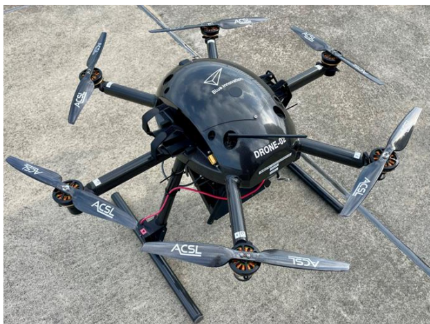
スピーカーを搭載した津波避難広報ドローン(宮城県仙台市)
