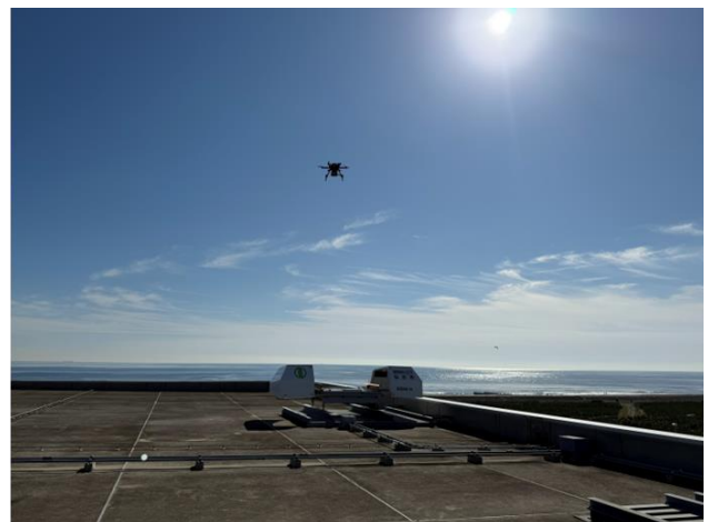
スピーカーを搭載した津波避難広報ドローン(宮城県仙台市)
