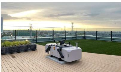
ドローンの離発着場。太陽光パネル点検や災害時物資配送の際などに活用できるポートを屋上に 2 ヶ所設置。また、敷地内の駐車場では利用者が持参したドローンポートを設置し、実験することも可能。
