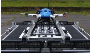
インフラ点検や緊急物資輸送の現場でのニーズが高まっている、より長時間・長距離飛行での運用や、全自動での運用に資する、汎用性、拡張性のあるドローンの離発着場(ドローンポート)の研究開発を行う。
