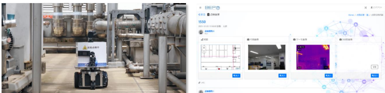
施設内を自動巡回する AGV(左)と「BEPサーベイランス」の管理画面(右)
