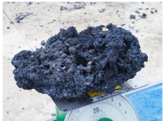
▼取り出した玉鋼を含む粗鋼の塊「鋸(ケラ)」
