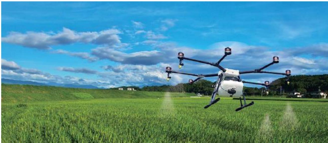
■約 10 分間の飛行一回で、最大 1 ヘクタール（10,000 m<sup>2</sup>）の農地に最大 10 リットルまで農薬散布可能。
