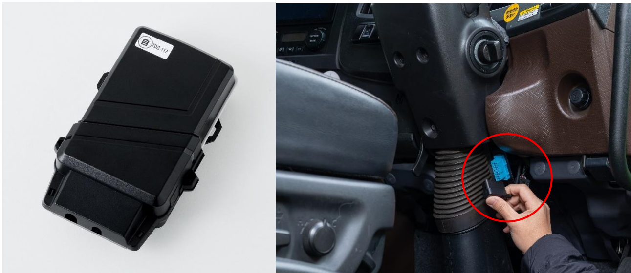
(左画像が本製品 OD420JP 本体。右画像の赤丸部分が OBD II 端子。)
