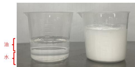
抱水性油剤が水分を抱え込む様子 上：水を入れる前 下：水を入れた後
