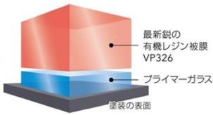
ECOプラスダイヤモンドキーパーのメカニズム
