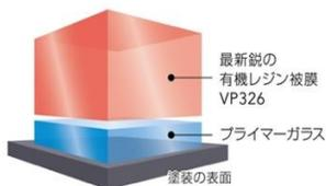
ECOプラスダイヤモンドキーパーのメカニズム
