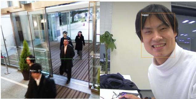
カメラで撮影した映像データをカメラに搭載した AI で解析し、顧客のニーズに合わせた必要な情報のみテキストデータでクラウド上へ送り、データ解析を行います。カメラ、解析サーバー、通信機器をオールインワンで提供します。画像データはカメラ内で削除されるため、大学や病院などの場所でもプライバシーに配慮しながら、安全確保やセキュリティの向上を図ることができます。1 台につき、電源 1 つで利用可能なため、コンパクトに設置できるうえ、導入コストの低減が可能です。これにより煩
