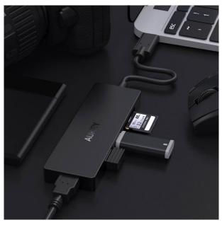
5. ケーブル固定 収納、持ち運び時に便利なケーブル固定タイプ。ケーブルは、忘れたり紛失したりする心配がな い直付けタイプです。
