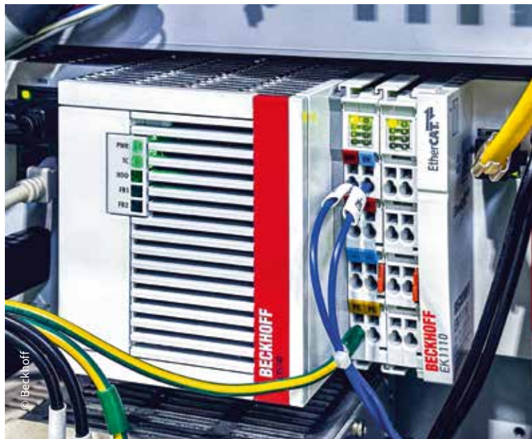
Intel Atom®を搭載したハイコストパフォーマンスモデルの組み込み型PC「CX5140」は射出成形機の制御コアとして機能。
