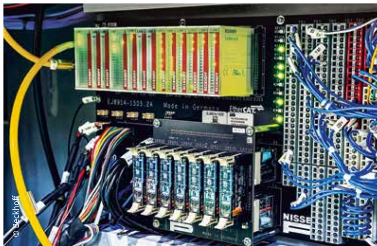
日精樹脂工業は、「EJモジュール」という汎用基板上に複数のIO機能を実装した専用モジュールを採用した（写真上部）。EJモジュールは必要なIO機能を1枚のボードにまとめられるため、IO部のコンパクト化とコスト削減のメリットがある。
