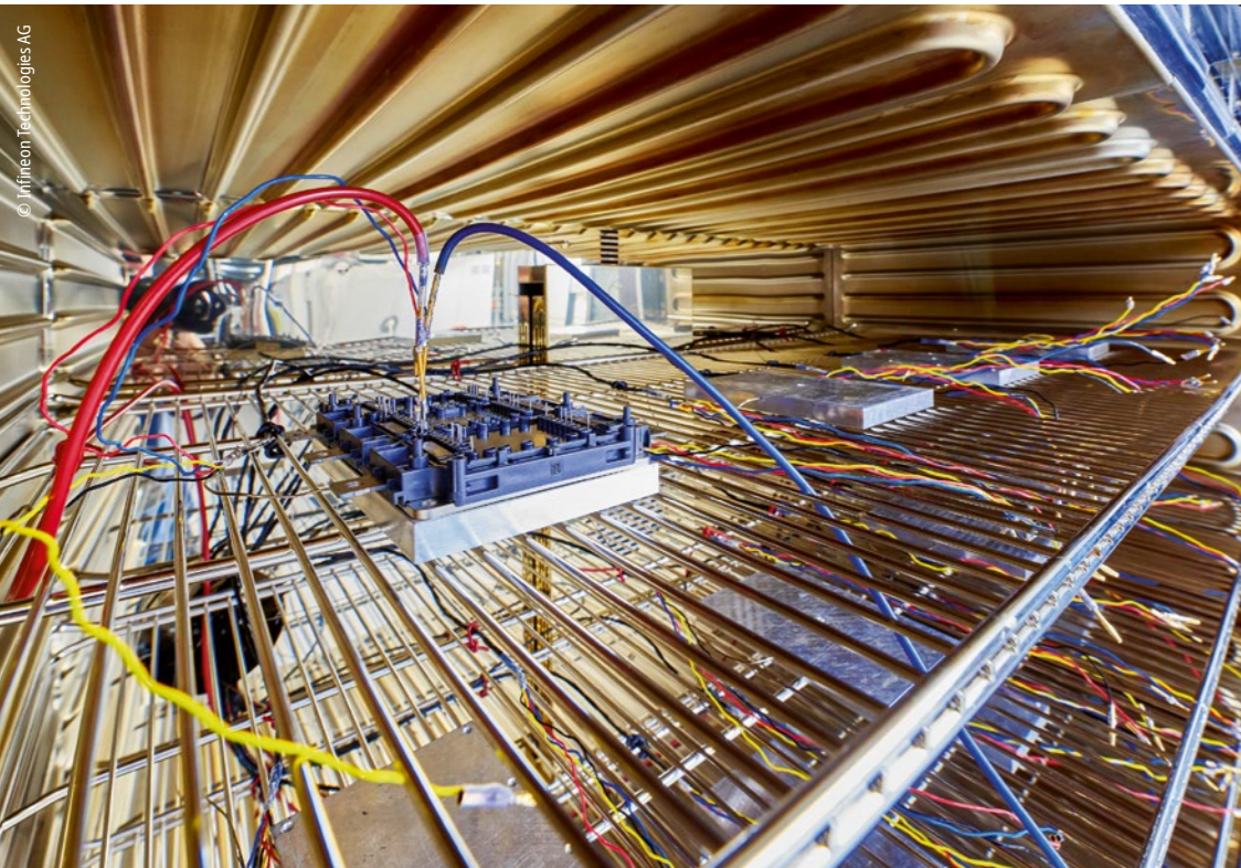
炉内の様子。最大32個のパワーモジュールの温度特性を算出するため、ELM3102-0100 EtherCAT計測ターミナルを用いて、異なる温度条件および定義された計測電流において電圧を24ビット分解能および0.01%精度で計測する。
