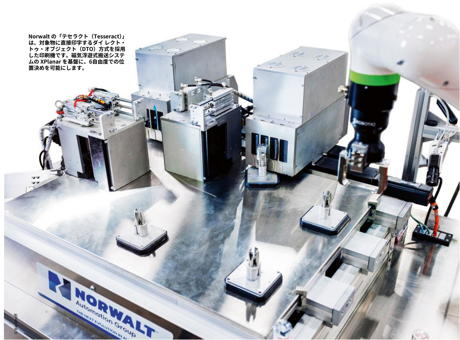
XPlanar可動子は、磁気浮遊しながら6自由度で移動できるため、印刷対象の容器をプリントヘッド周辺で最適に搬送し、高品質な印字を実現します。
